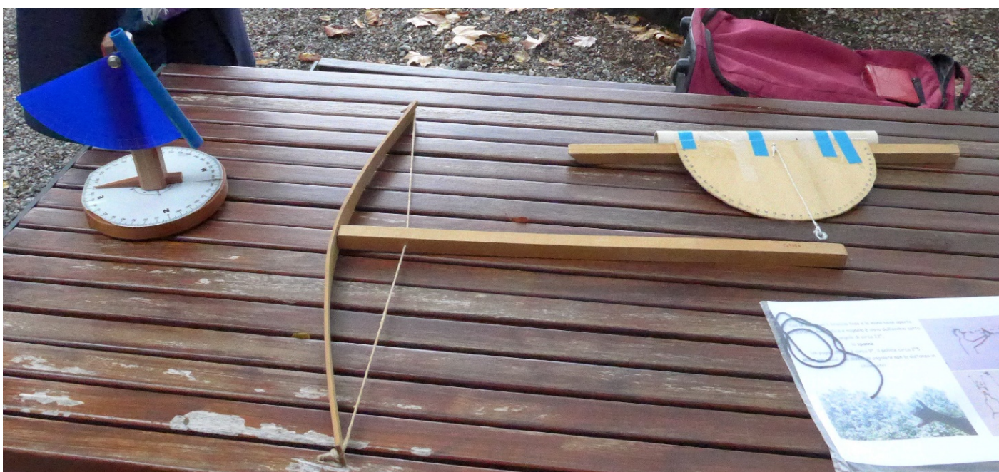
Figura 5. Foto di alcuni strumenti dell'autrice: lo strumento altazimutale, la balestra celeste e uno strumento per misurare l'altezza di un astro.
